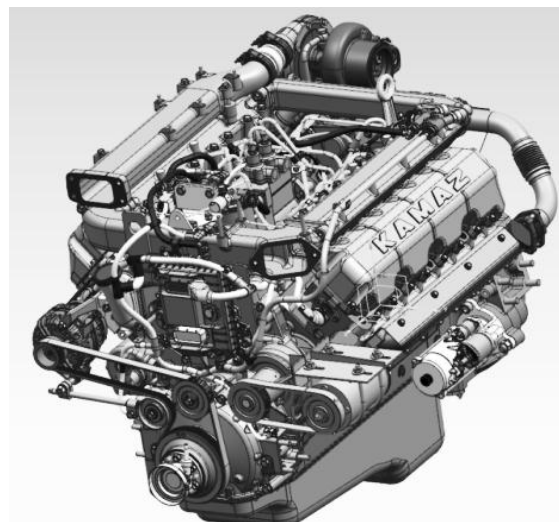
Рис.19 – Тестовый двигатель с электрическим приводом водяного насоса
