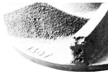
Рис.23 - Эрозия РК КАМАЗ вследствие кавитации.
